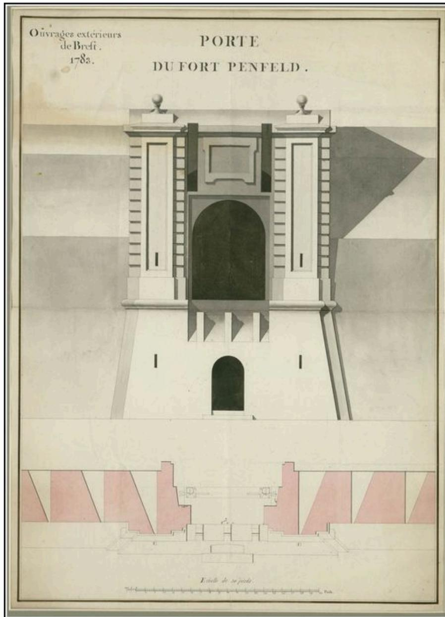
Elévation et plan de la porte du fort de Penfeld (les axes du pont-levis sont visibles), 1783
