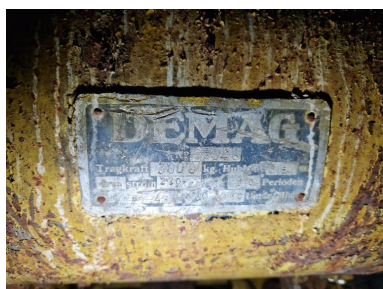
Vue de l'extension nord-ouest : détail de la plaque constructeur du treuil du troisième étage servant de magasin. On peut lire la marque DEMAG et des renseignements techniques Phot. Guillaume Lécueillier IVR53_20245610110NUCA
