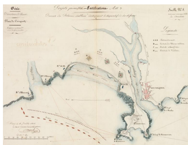
Plan du dispositif de défense des Blancs Sablons, feuille de dessin des projets pour 1846, 11 juillet 1846. Le dispositif de défense combine l'action des batteries de côte, des retranchements, des redoutes et de troupes mobiles
