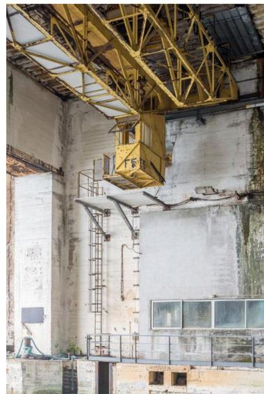
Vue de l'alvéole G (n° 13 et 14) : quai ouest n° 14 et pont roulant d'une capacité de 5 tonnes
