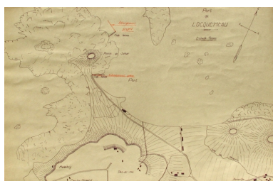
Plan du port en 1930 (échelle 1/50 000), avec l'allongement projeté de la cale basse et l'exhaussement de la cale haute (AD 22) Repro. Guy Prigent, Autr. Hélyary Rapilly IVR53_20042204476NUCB
