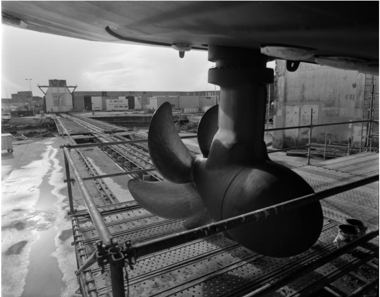
Vue de la quatrième ligne de réparation en 2000 (voie située à l'opposé de celle du dom-bunker ouest). Au premier plan, détail de l'un des deux propulseurs azimutaux du Vindilis de Vannes (navire roulier de la ligne Quiberon - Belle-Île)
