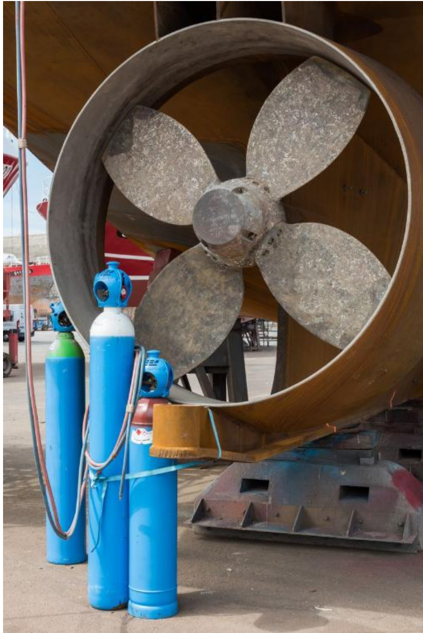
Vue de détail d'un bateau en carénage sur le terre-plein : hélice quadripale
