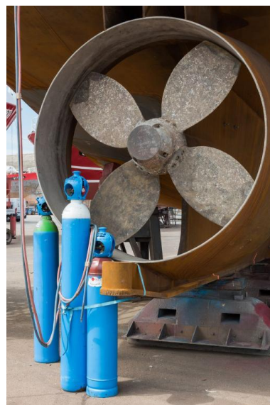
Vue de détail d'un bateau en carénage sur le terre-plein : hélice quadripale Phot. Charlotte Barraud IVR53_20215600581NUCA
