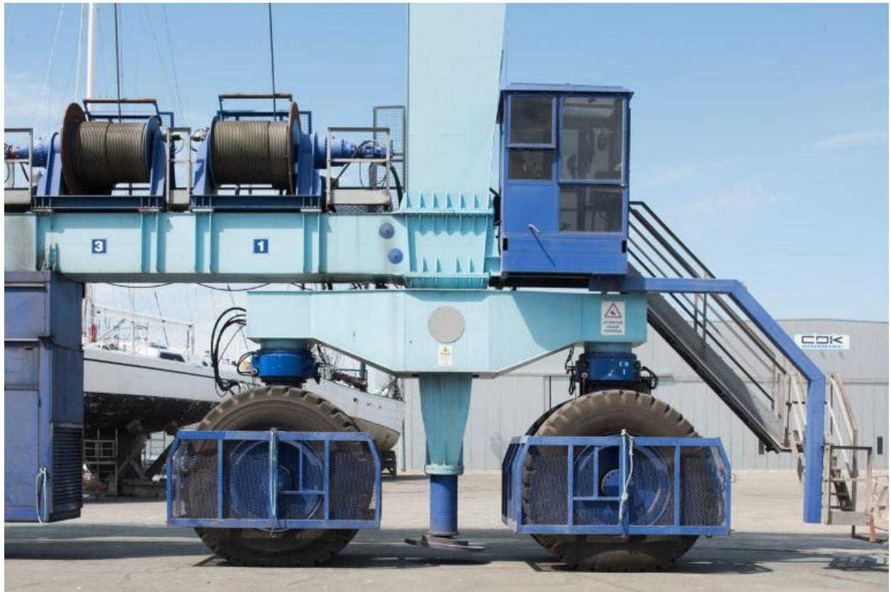
Vue de détail de l'élévateur à bateaux
