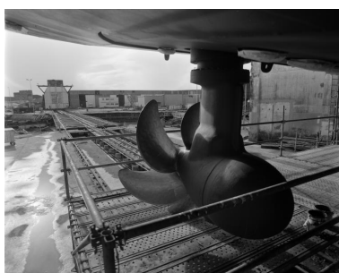
Vue de la quatrième ligne de réparation en 2000 (voie située à l'opposé de celle du dom-bunker ouest). Au premier plan, détail de l'un des deux propulseurs azimutaux du Vindilis de Vannes (navire roulier de la ligne Quiberon - Belle-Île) Phot. Bernard Bègne
