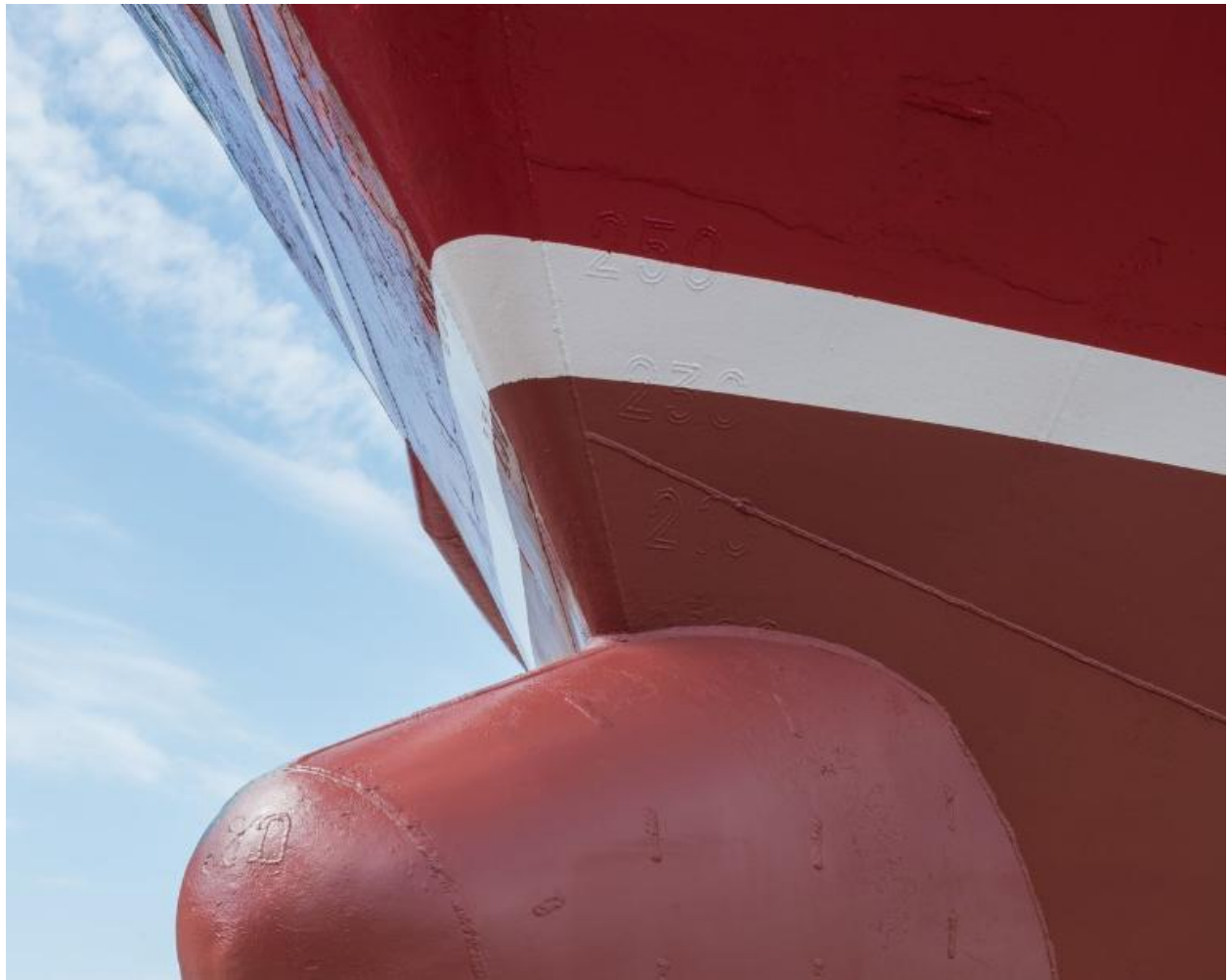
Vue de détail d'un bateau en carénage sur le terre-plein : bulbe
