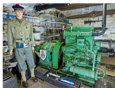
Vue intérieure : salle des machines pour deux groupes électrogènes, moteur Renault type D7, n° 152, 1941 (déplacé, ce moteur provient de la centrale électrique de Kernével à Larmor-Plage). Ce bunker-musée a pour thématique la Seconde Guerre mondiale Phot. Bernard Bègne IVR53_20255600883NUCA
