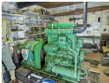
Vue intérieure : salle des machines pour deux groupes électrogènes, moteur Renault type D7, n° 152, 1941 (déplacé, ce moteur provient de la centrale électrique de Kernével à Larmor-Plage). Ce bunker-musée a pour thématique la Seconde Guerre mondiale Phot. Bernard Bègne IVR53_20255600884NUCA
