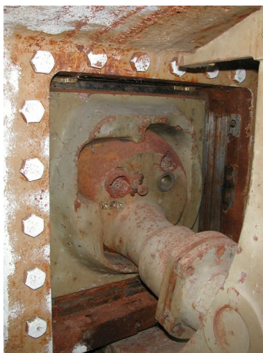
Vue du canon antichar Skoda de 4,7 cm : détail de la rotule (état en 2004) Phot. Guillaume Lécueillier
