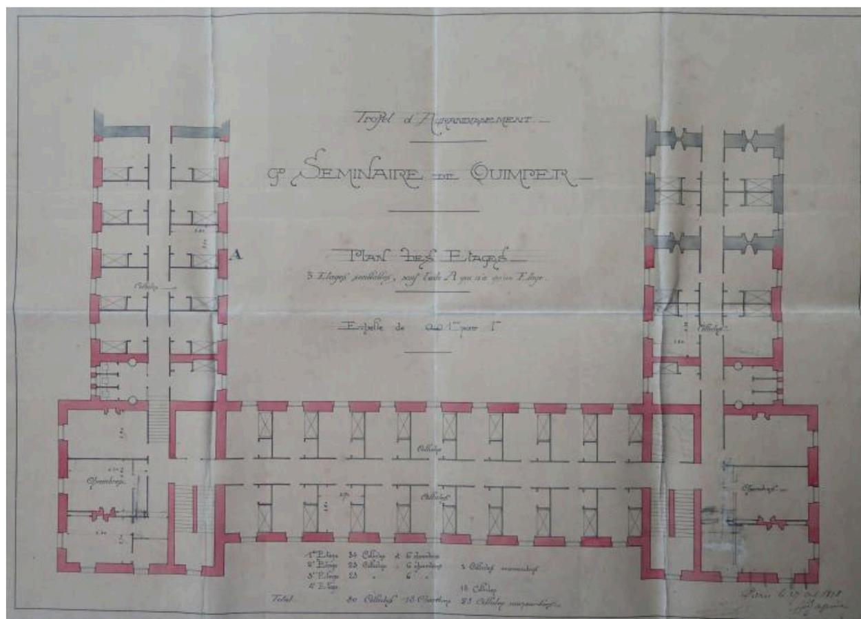
Grand Séminaire. Projet d'agrandissement. Plan des étages. Henri Rapine, architecte, 1898. Noter l'ajout de 3 travées, et donc, la reconstruction de cette aile, au sud-ouest de l'emplacement de l'aile démolie.
