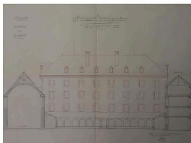
Élévation côté cour de l'aile à reconstruire et à exhausser (aile nord-est, la coupe de la chapelle, à gauche peut servir de repère). Joseph Bigot architecte, 25 octobre 1854. Le cloître de ce côté là, est conservé et demeurera par la suite.
