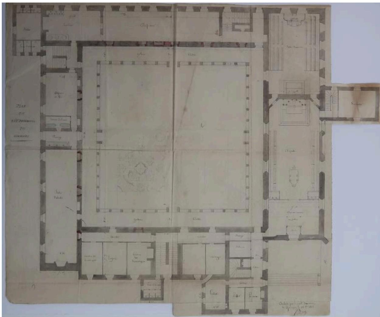
Plan du rez-de-chaussée du séminaire, par Joseph Bigot, octobre 1859. Etat avant les travaux de reconstruction de trois des ailes. Dans le prolongement de la chapelle, la salle pour s'exercer à la célébration de la messe.
