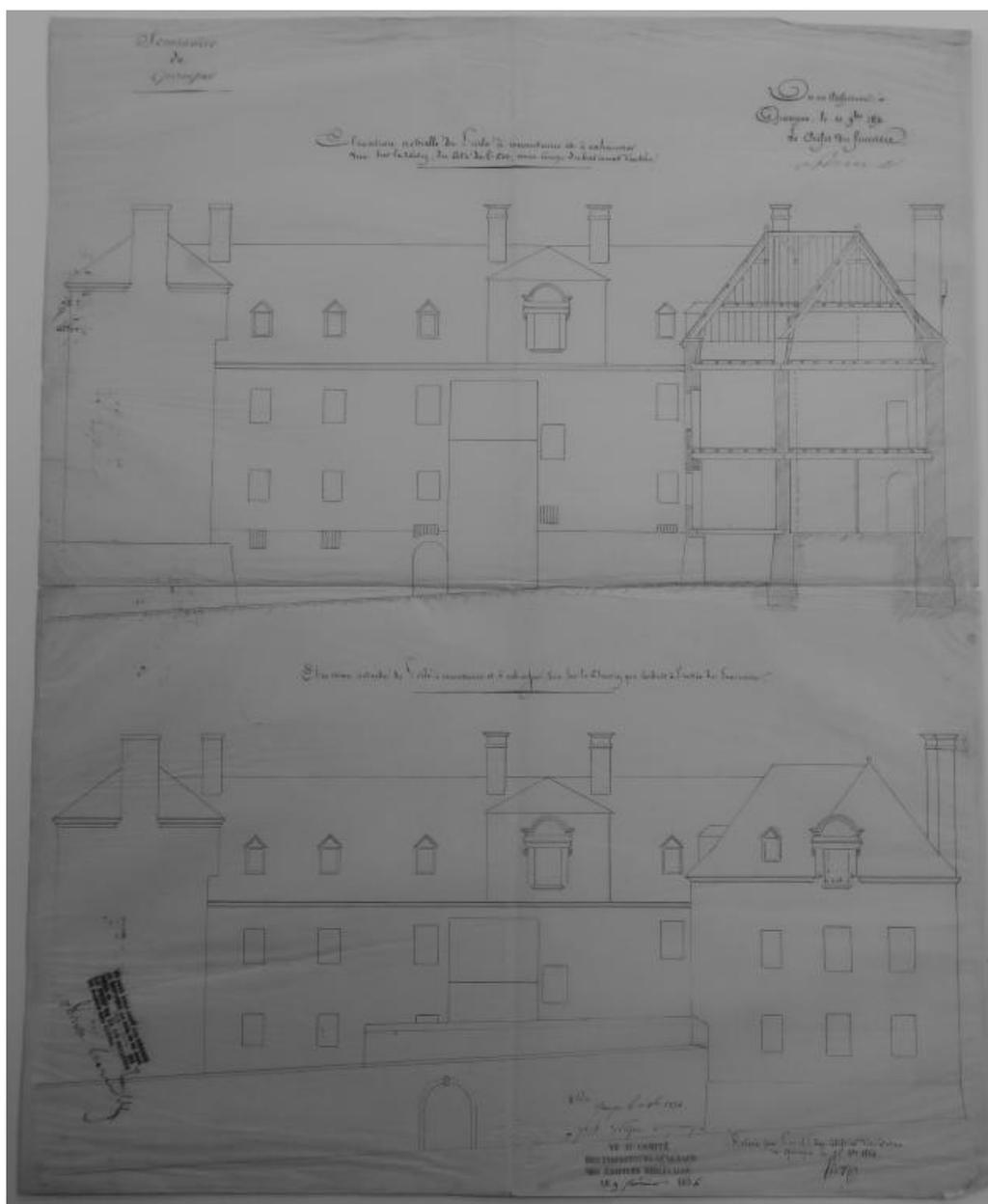
Élévations et coupe de la façade nord-est de l'aile nord-est, avant les grands travaux de reconstruction des années 1850-1900. Relevé effectué par Joseph Bigot, architecte diocésain, en 1859.
