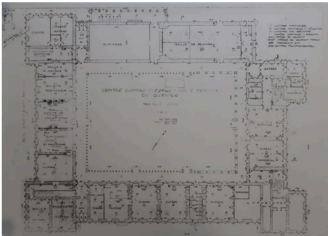
Centre d'apprentissage féminin de Quimper. Plan du rez-de-chaussée. Jacques Lachaud, architecte, 1953, 1958, 1960. Ce plan représente l'implantation de l'établissement dans l'ancien séminaire. Noter, entre autres, le gymnase au nord, les ateliers à l'ouest, les classes au sud... (Ce plan et ceux des autres étages sont en annexes PDF de ce dossier.)
