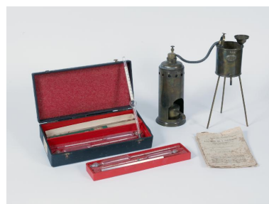
Densimètres, alambic fabriqué par Dujardin-Salleron et notice explicative pour l'essai des vins (deuxième moitié du 19e siècle) du lycée Joseph Loth à Pontivy Phot. Bernard Bègne IVR53_20195600001NUCA
