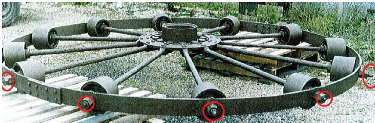
Mécanisme de rotation du pont : pivot central, galets, crémaillère courbe (document de suivi de travaux)
