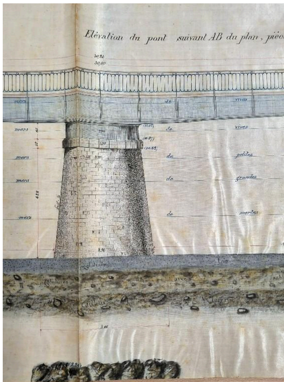
Elévation du pont tournant, pile centrale (28 mai 1891)
