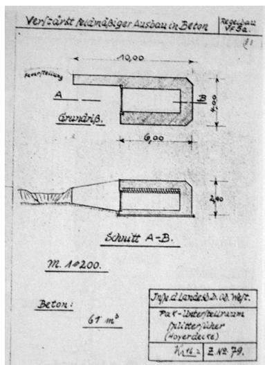
Plan d'un bunker-abri-garage de type VF 5a (Verstärkt feldmässiger Ausbau in Beton, Regelbau VF5a : Pak-Unterstellraum, Splittersicher [pare-éclats], Hoyerdecke [poutres Hoyer])
