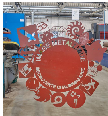
Réalisation d'élèves en chaudronnerie (découpe plasma). Phot. Bernard Bègne IVR53_20212900073NUCA
