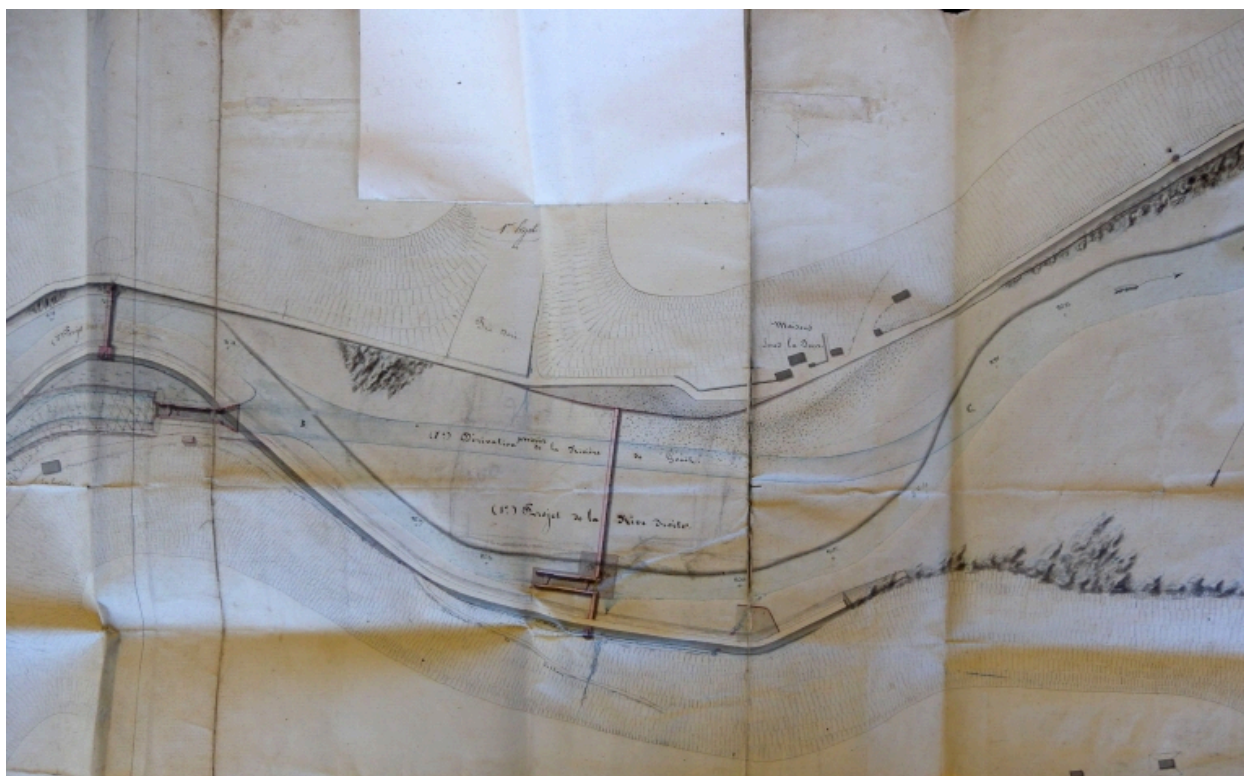
Avant-projet du bassin à flot en 1839 : projet de dérivation provisoire de la rivière du Gouët, rive droite, canal de l'avant-port (AD 22)
