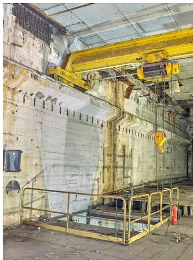
Vue de la salle du groupe turbo-dynamo (fonction en 1945), puis local des bouilleurs situé au premier étage de l'extension sud : puits monte-charge et pont roulant de la période allemande modernisé (PB2-80)
