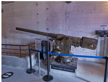
Vue d'un canon antiaérien de 88 mm provenant d'un sous-marins allemand (collection du musée). Ce type de canon était utilisé lors des navigations en surface
