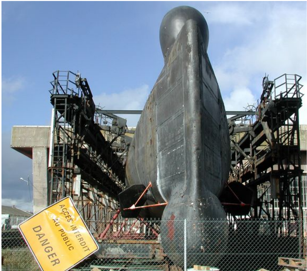
Vue du sous-marin Flore en 2002 (S645, classe Daphné, lancé en 1960) sur le plateau de translation doté de deux berceaux. Le sous-marin Flore y repose à sec depuis le 12 juillet 1995
