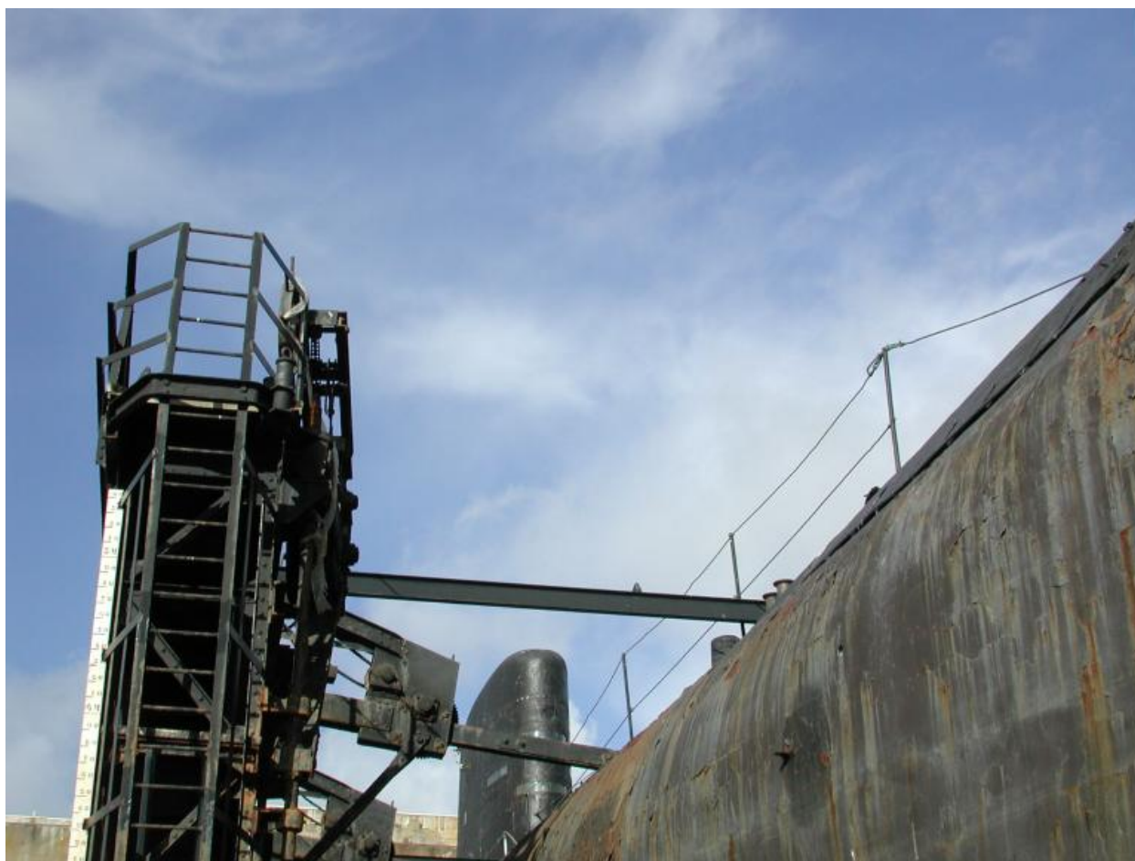
Détail de l'un des deux berceaux du plateau de translation sur lequel repose le sous-marin Flore (2002)
