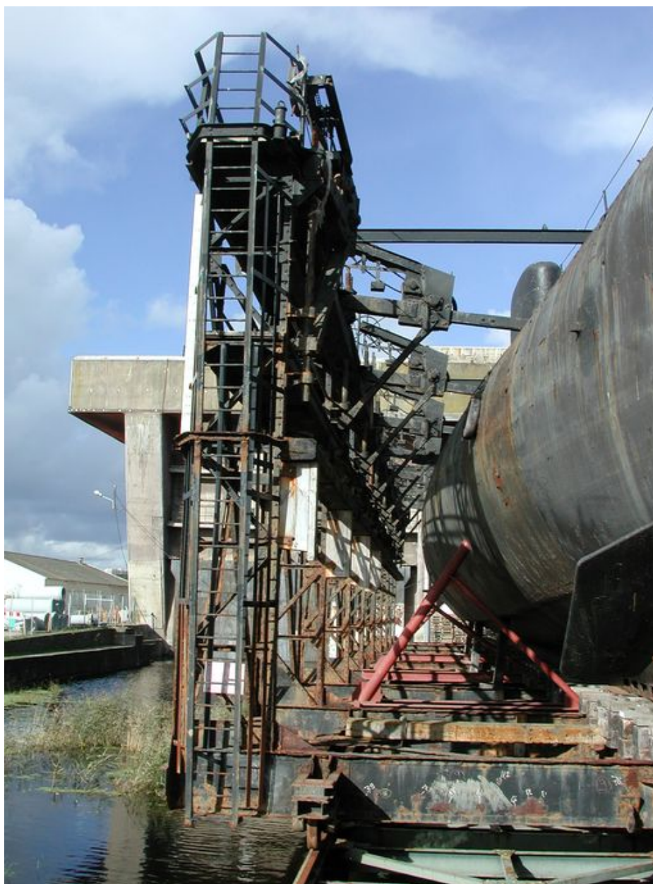
Détail de l'un des deux berceaux du plateau de translation sur lequel repose le sous-marin Flore (2002)
