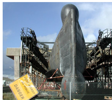
Vue du sous-marin Flore en 2002 (S645, classe Daphné, lancé en 1960) sur le plateau de translation doté de deux berceaux. Le sous-marin Flore y repose à sec depuis le 12 juillet 1995 Phot. Guillaume Lécueillier IVR53_20055603497NUCA
