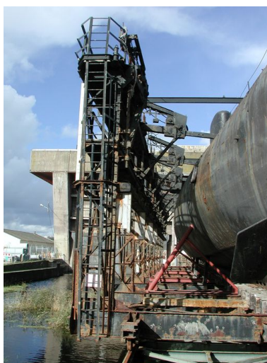
Détail de l'un des deux berceaux du plateau de translation sur lequel repose le sous-marin Flore (2002) Phot. Guillaume Lécueillier IVR53_20055603499NUCA
