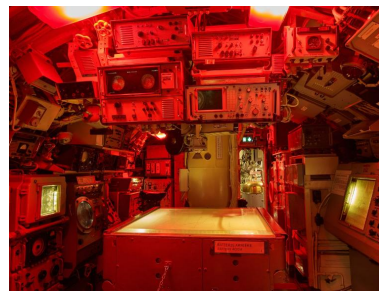
Vue intérieure du sous-marin Flore : central d'opération, table traçante pour la navigation Phot. Bernard Bègne IVR53_20215600548NUCA
