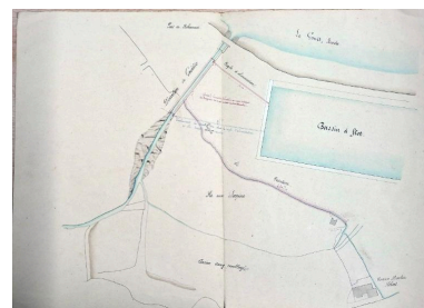
Plan de situation de l'alimentation du bassin par les eaux du Gouëdic, plan dressé par l'ingénieur De La Tribonnière, 31 octobre 1859 Repro. Erwana L'Haridon IVR53_20262210198NUCA
