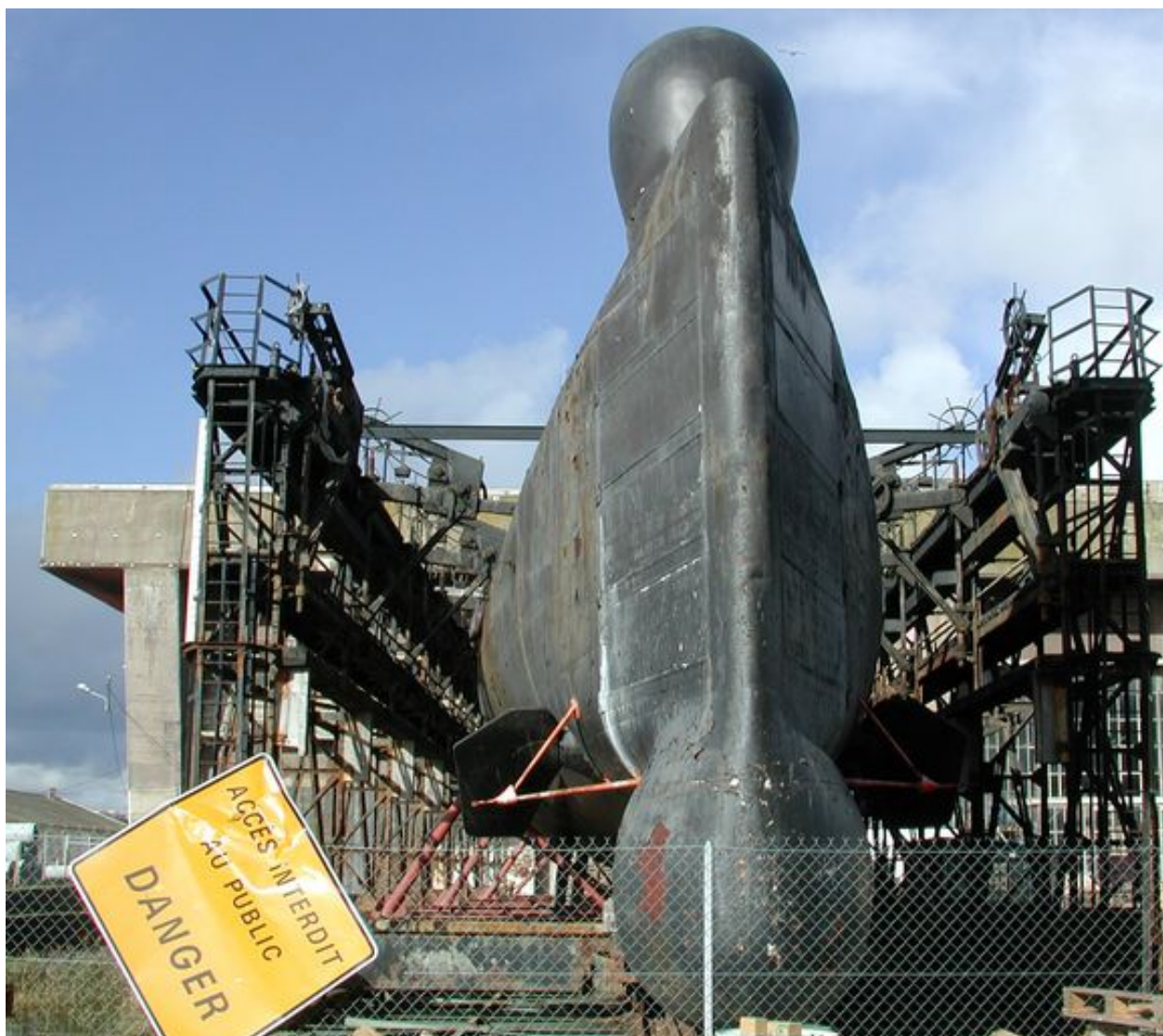
Vue du sous-marin Flore en 2002 (S645, classe Daphné, lancé en 1960) sur le plateau de translation d'origine allemande doté de deux berceaux. Le sous-marin Flore y repose à sec depuis le 12 juillet 1995
