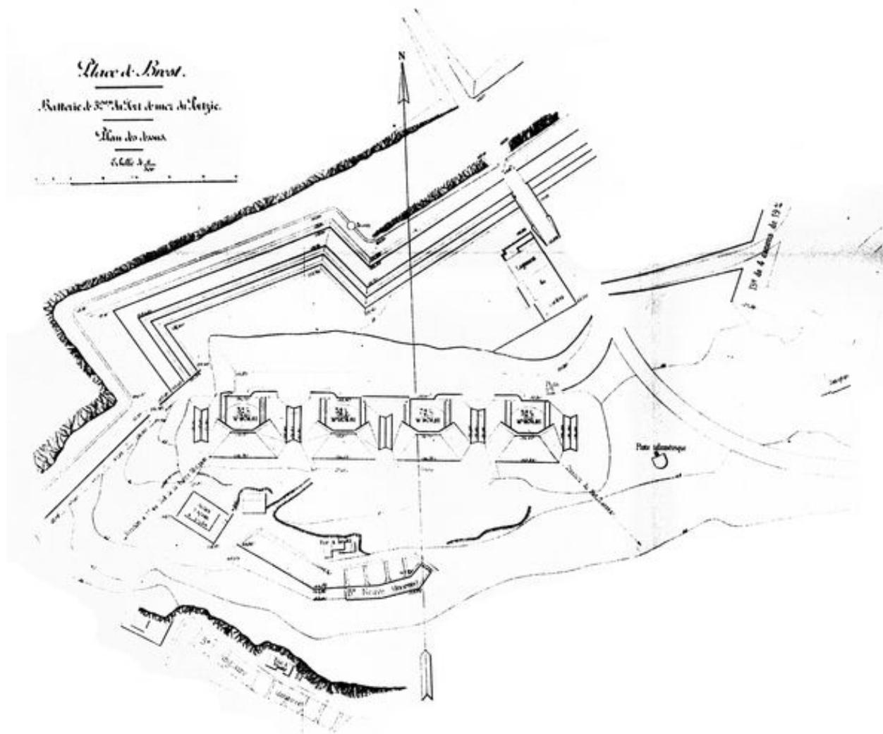
Plan de situation de la batterie du fort de mer (4 canons M de 32 cm modèle 1870-1881 sur affûts M modèle 1882 PA)
