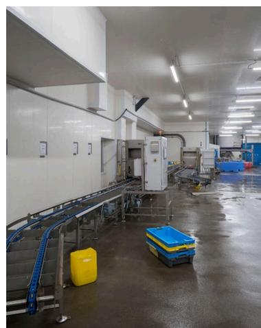
Convoyeur avec dépileur à caisses
