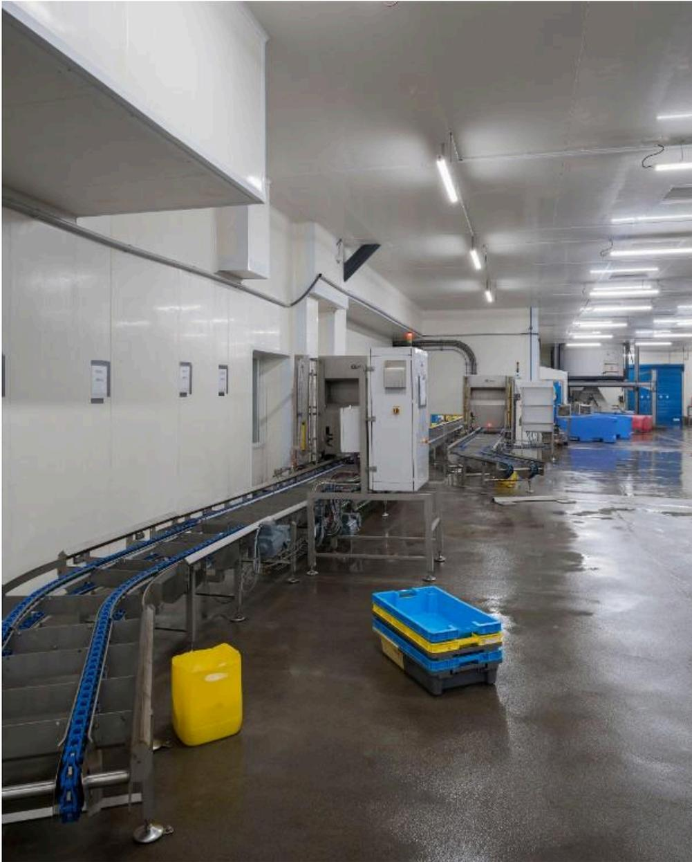
Convoyeur avec dépileur à caisses
