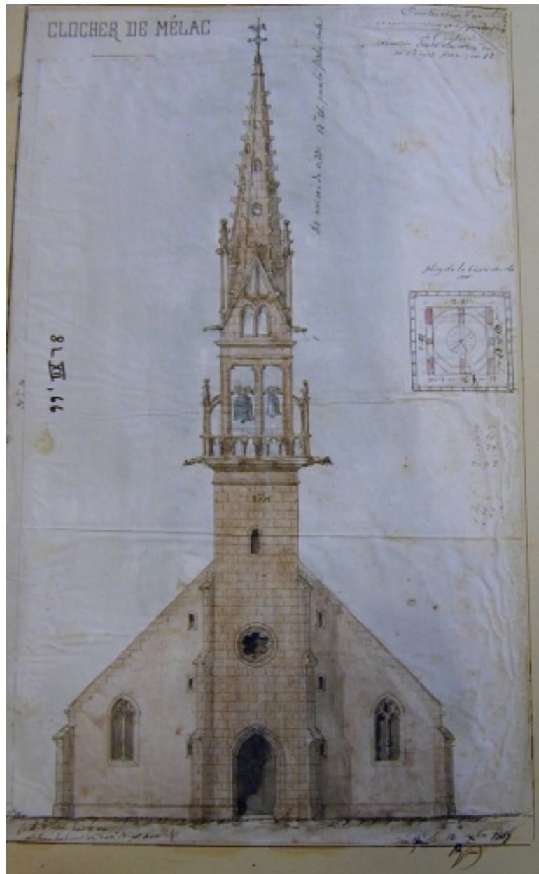
Mellac, église paroissiale Saint-Pierre-aux-Liens : élévation occidentale et plan de la chambre des cloches. Projet Joseph Bigot, 1857, reproduction de 2001
