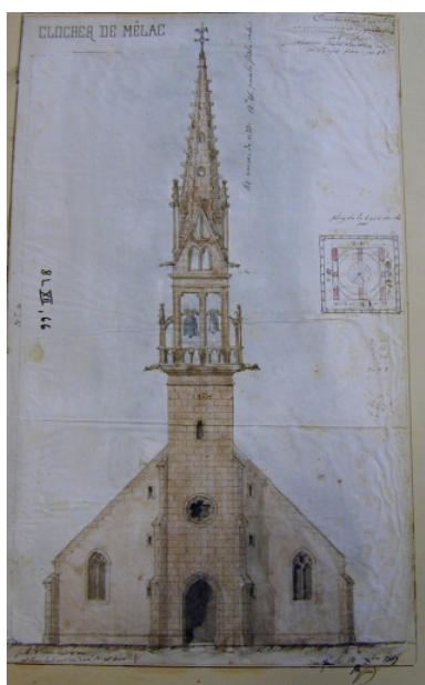
Mellac, église paroissiale Saint-Pierre-aux-Liens : élévation occidentale et plan de la chambre des cloches. Projet Joseph Bigot, 1857, reproduction de 2001 Repro. Christel Douard IVR53_20012916685NUCA
