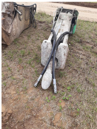
Vue de la déconstruction : brise- roche hydraulique utilisé par l'engin de terrassement (2 octobre 2022) Phot. Simon Roudot IVR53_20222905952NUCA
