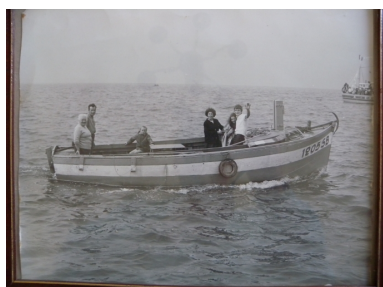
Vue du petit chalutier demi-ponté 'Marie-Josée 1', 20 pieds de long, avec mât à bascule, construit par le chantier Lanier à Saint-Malo (collection particulière) Repro. Guy Prigent IVR53_20082213146NUCB
