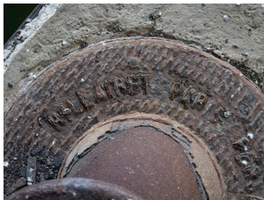
Vue de l'un des deux cabestans électriques à commande à pédale. L'inscription HILLAIRET PARIS-PERSAN est moulée sur le marchepied du cabestan et sur chacune des poupées Phot. Bernard Bègne IVR53_20235600625NUCA
