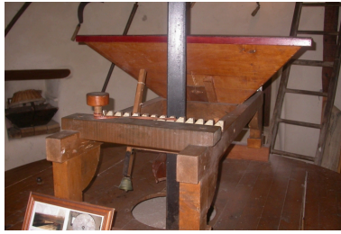
Trémie et meule à l'étage Phot. Jérôme Cucarull IVR53_20052203310NUCA
