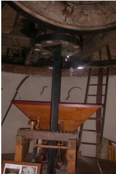
Trémie et meule à l'étage Phot. Jérôme Cucarull IVR53_20052203309NUCA
