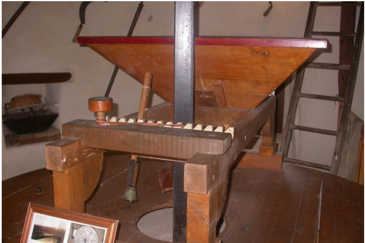
Trémie et meule à l'étage
