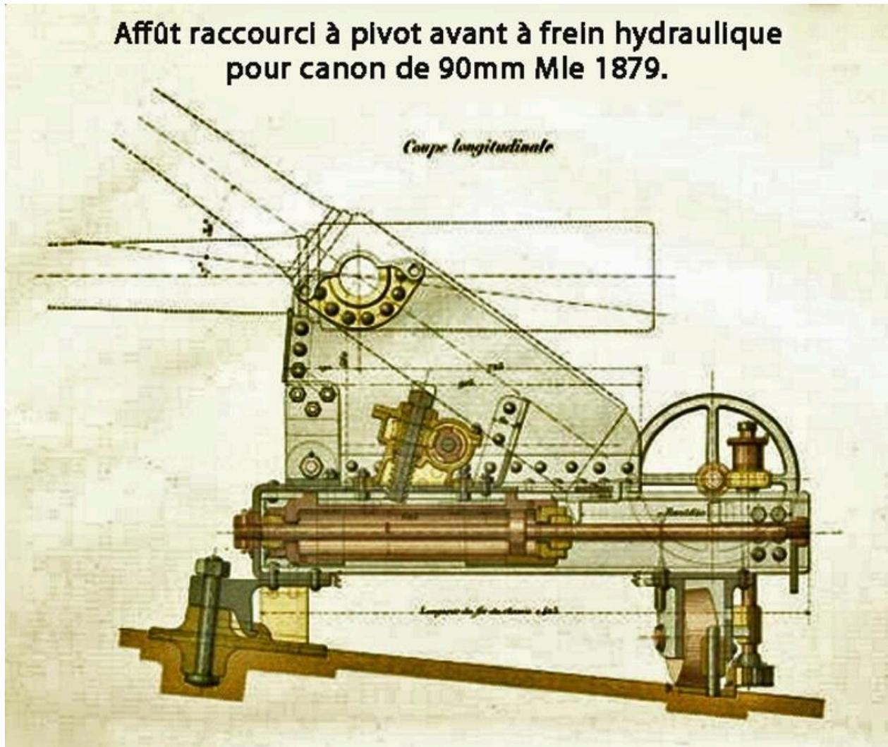
Affût raccourci à pivot avant à frein hydraulique pour canon de 90 mm modèle 1879
