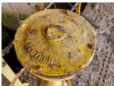
Vue de l'une des deux commandes de pompe sur le bateau-porte fermant le bassin. On peut lire : BOPP et REUTHER VANNHEIM. Elle fonctionnait avec une manivelle Phot. Bernard Bègne IVR53_20235600620NUCA
