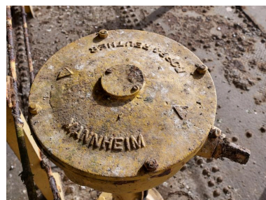
Vue de l'une des deux commandes de pompe sur le bateau-porte fermant le bassin. On peut lire : BOPP et REUTHER VANNHEIM. Elle fonctionnait avec une manivelle Phot. Bernard Bègne IVR53_20235600621NUCA
