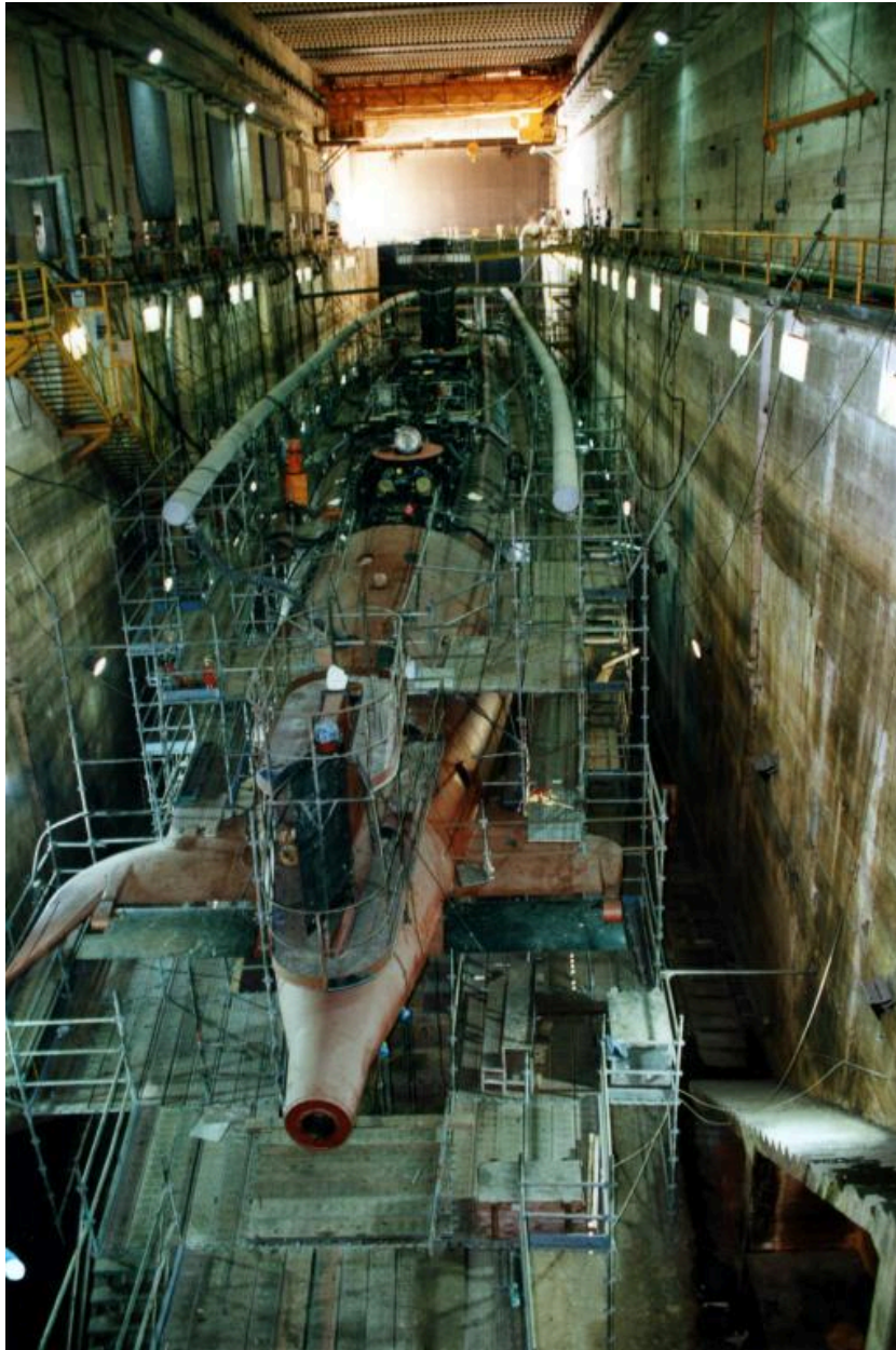
Vue du sous-marin Agosta en grand carénage dans l'alvéole A du bunker Keroman III à Lorient (1991-1992 ?)
