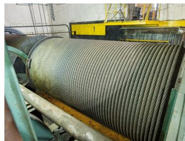
Vue de l'un des deux tambours du treuil sur lequel est enroulé le câble. Les tambours mesurent 2 m de diamètre Phot. Bernard Bègne IVR53_20235600196NUCA
