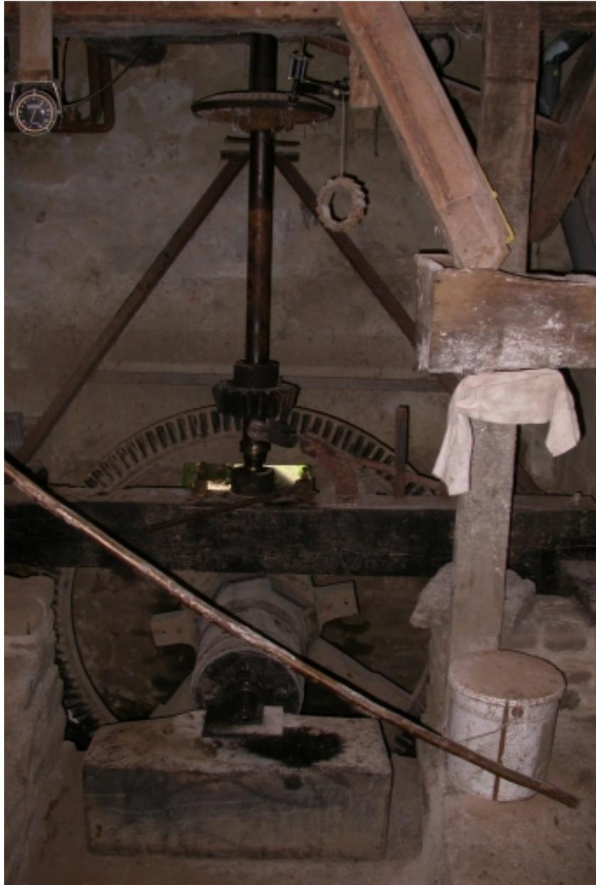
Engrenages de la roue au rez-de-chaussée
