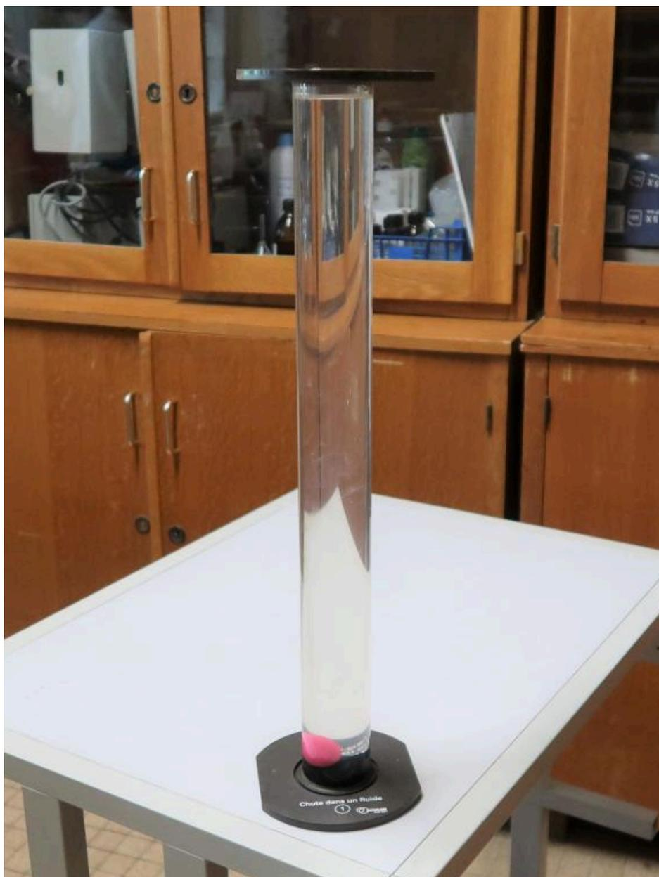
Appareil de chute dans un fluide - Pesanteur-Mécanique-Mesure (Jeulin)
