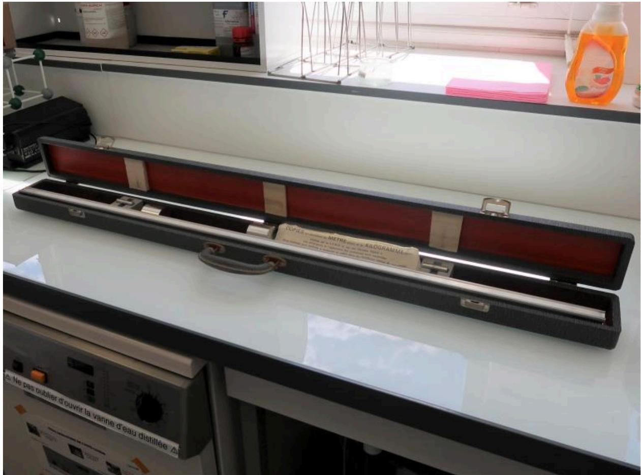
Modèle de mètre-étalon à traits - Pesanteur-Mécanique-Mesure (C.E.M.S., 1969)
