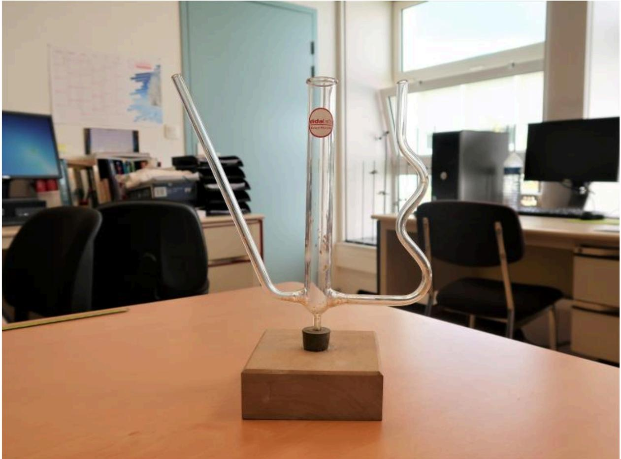
Appareil des vases communicants - Hydrostatique-Hydrodynamique (Didalab)
