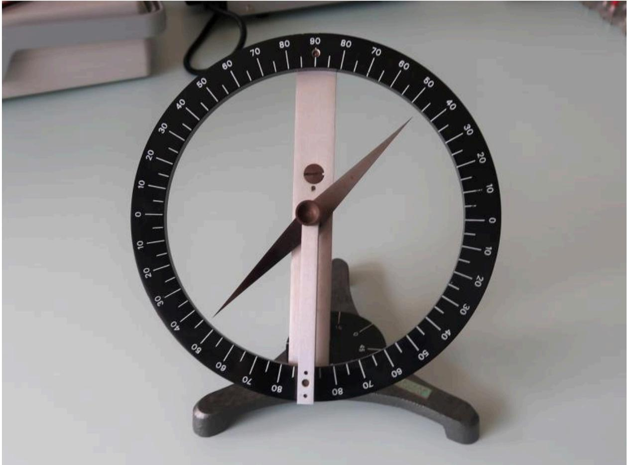
Boussole d'inclinaison - Magnétisme (Eurosap Deyrolle)
