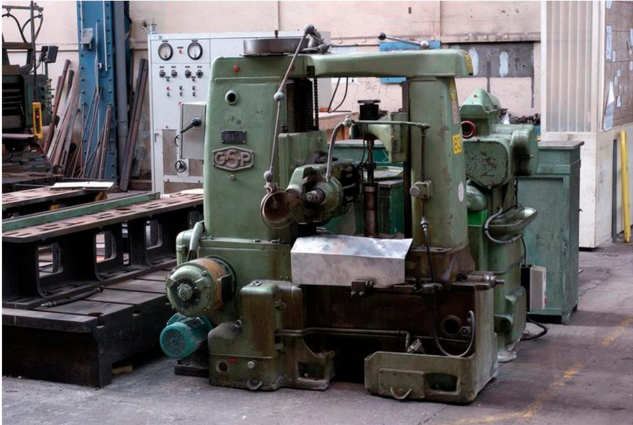
Vue de la halle d'usinage : machine à tailler les engrenages
