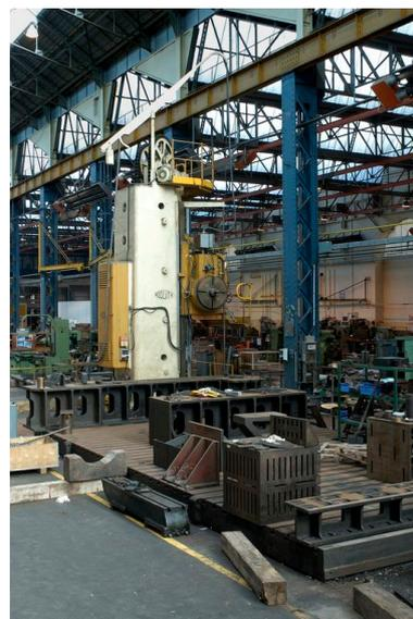
Vue de la halle d'usinage : aléuseuse
