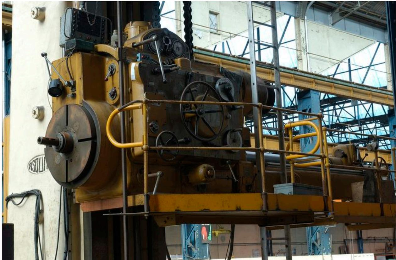
Vue de la halle d'usinage : aléuseuse Malf Asquith, cabine du conducteur
