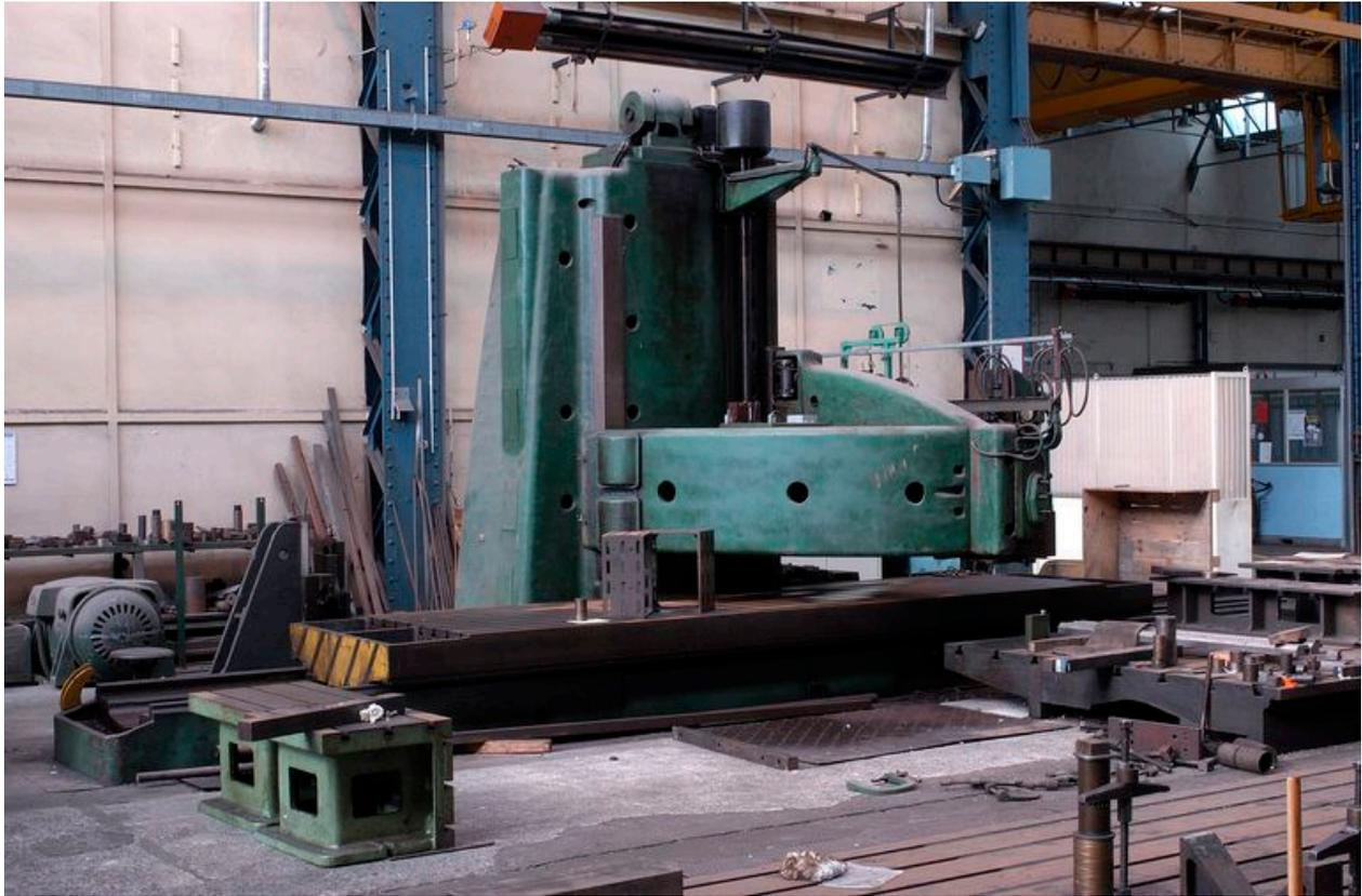
Vue de la halle d'usinage : aléseuse Berthiez (1949)
