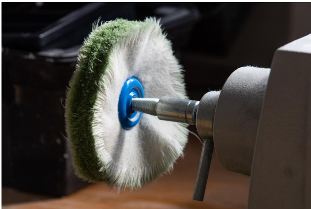
Bâtiment G, atelier optique - lunetterie : polisseuse.
