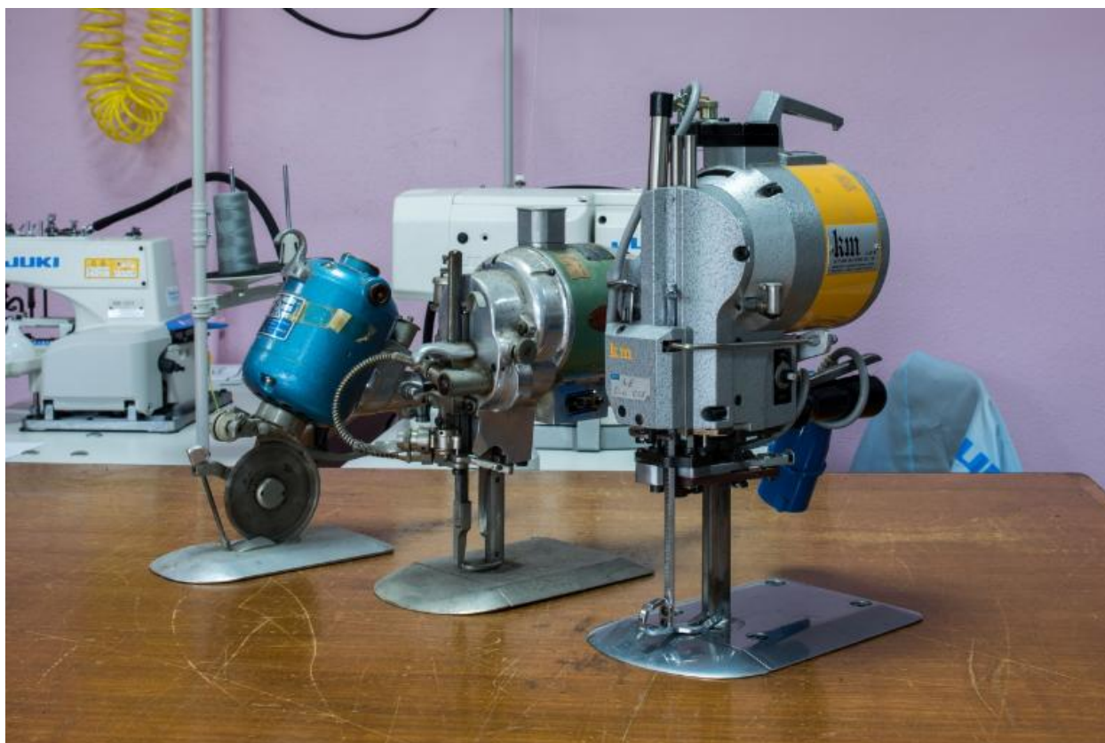
Atelier couture (bâtiment F), formation mode - vêtement : ciseaux électriques.
