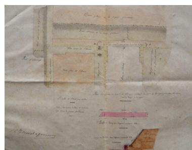
Plan et profil d'un éperon en maçonnerie, construit au pied de la digue provisoire du bassin à flot, 1886 (AD 22)
