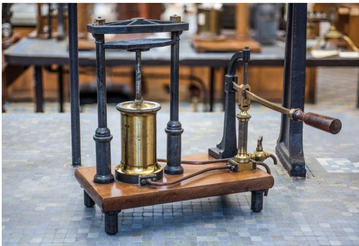
Presse hydraulique - Hydrostatique-Hydrodynamique (E. Ducretet)
