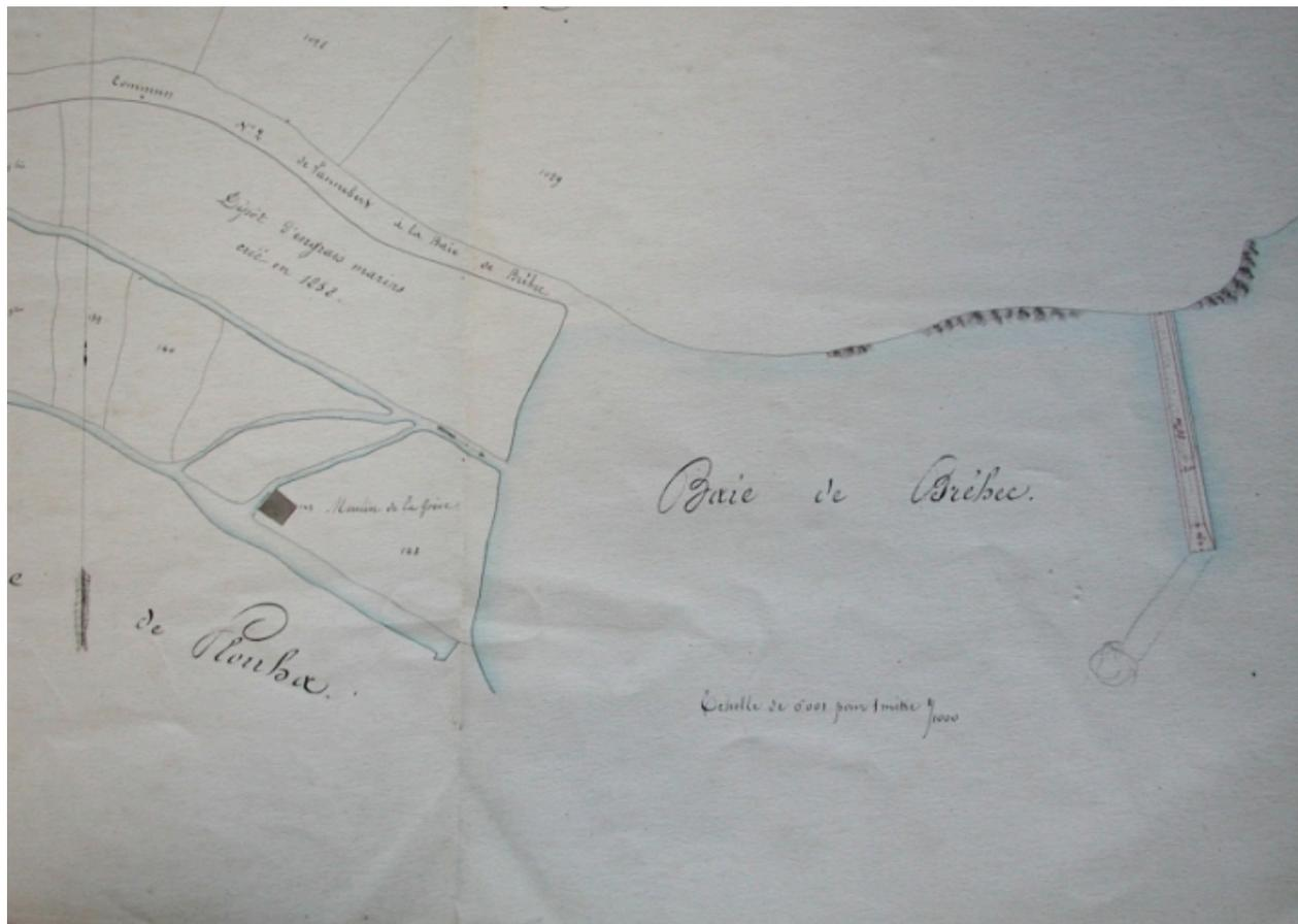
plan de 1862 pour l'agrandissement du dépôt d'engrais marins à Bréhec, avec le projet de nouvelle digue
