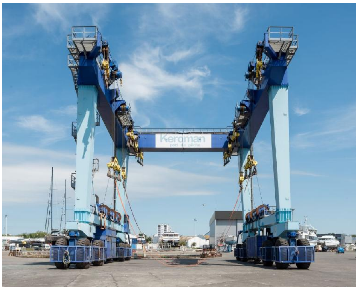
Vue de l'élévateur à bateaux d'une capacité de 650 tonnes
