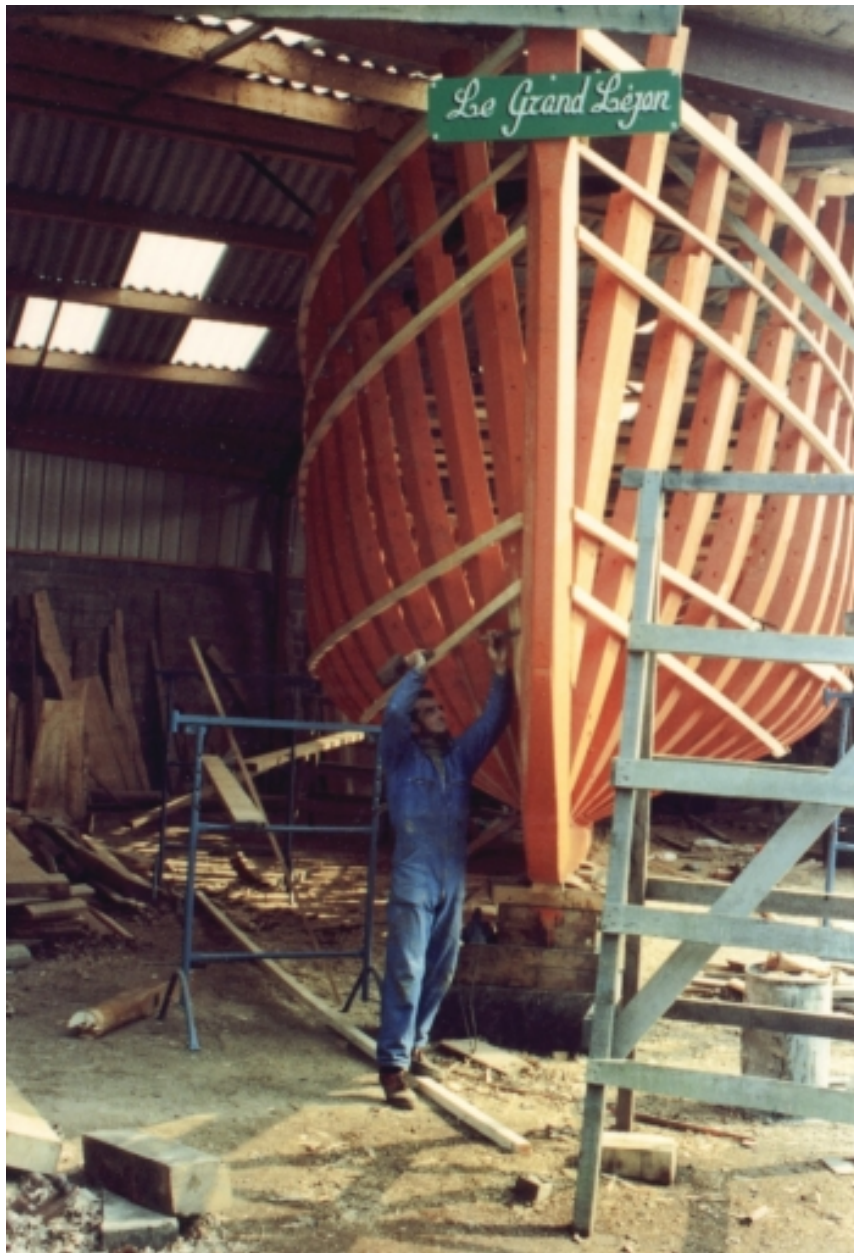
Vue de la charpente avant de la coque membrée avec les lisses, au chantier Clochet (collection particulière, Association le Grand Léjon)
