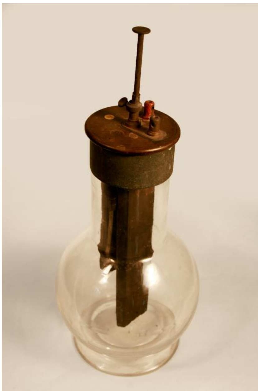
Pile de Grenet au dichromate de potassium - Electricité dynamique (Non signé)
