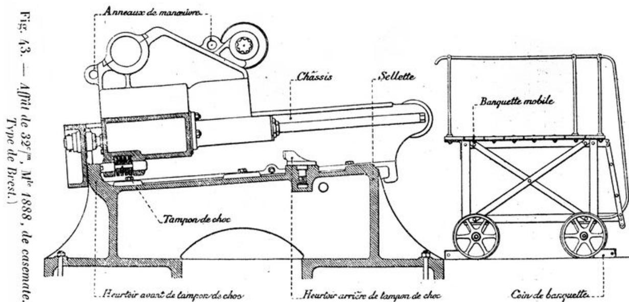
Plan détaillé d'un affût de canon de 32 cm modèle 1888 de casemate : Type de Brest
