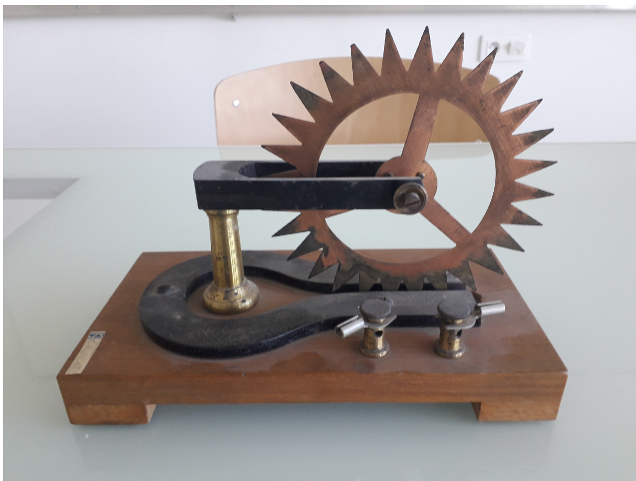
Roue de Barlow - Electricité dynamique (Non signé). Etiqueté "Lycée Charcot"
