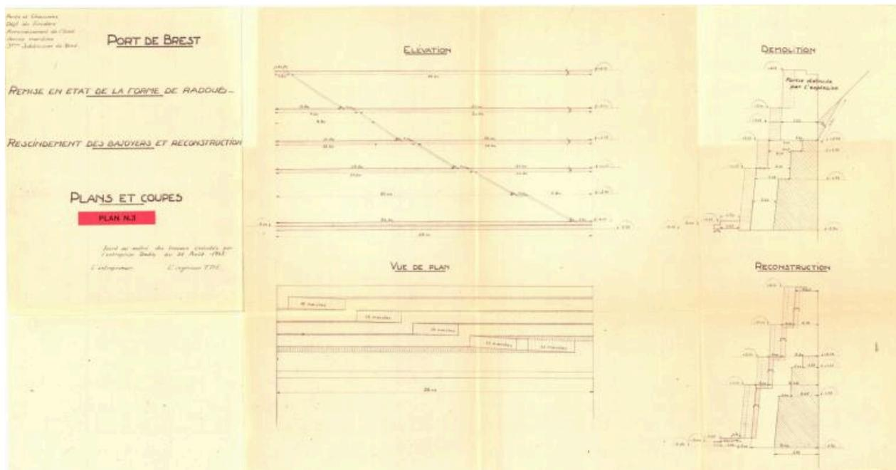
Remise en état de la forme de radoub, rescindement des bajoyers et reconstruction, plans et coupes (1948)
