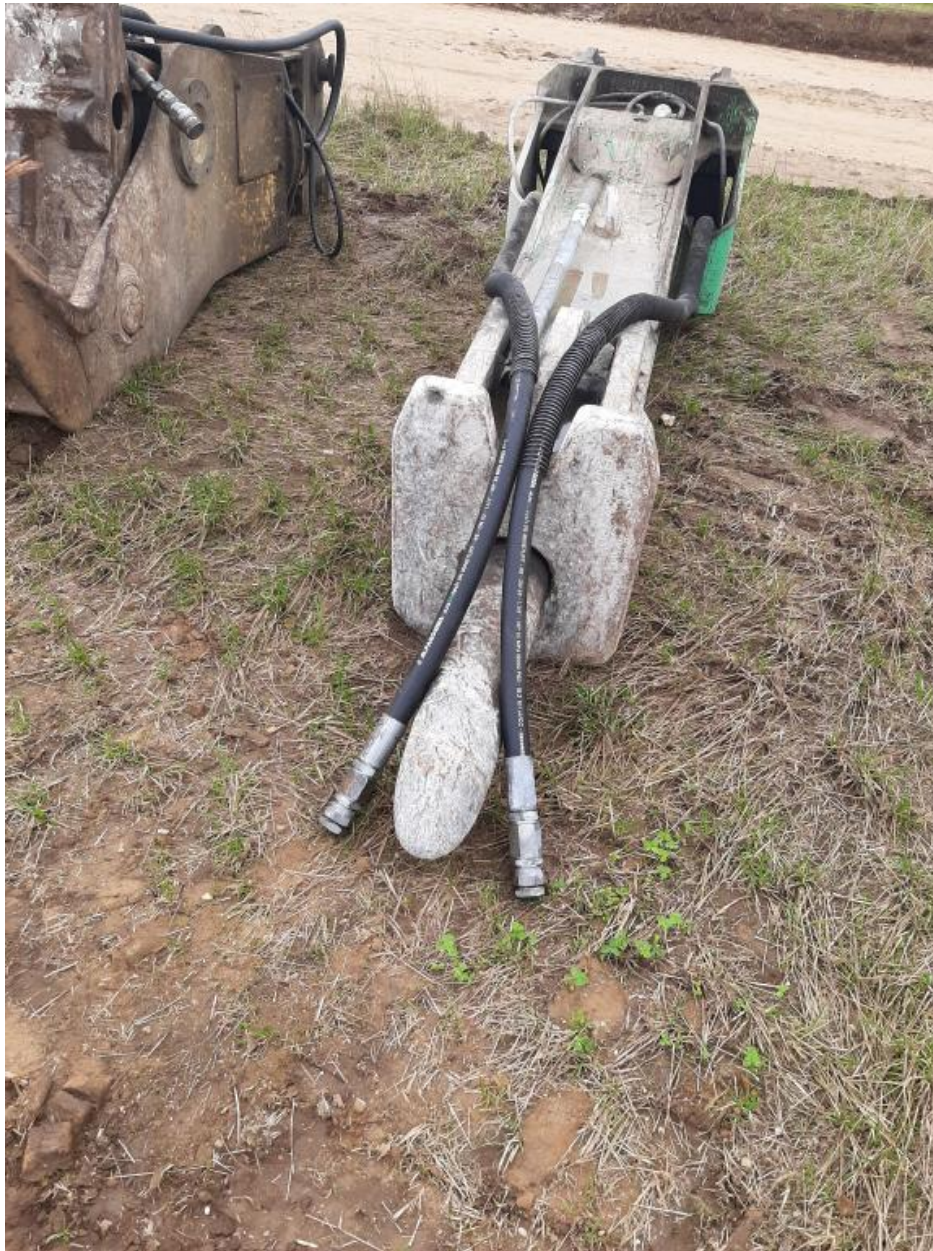
Vue de la déconstruction : brise-roche hydraulique utilisé par l'engin de terrassement (2 octobre 2022)
