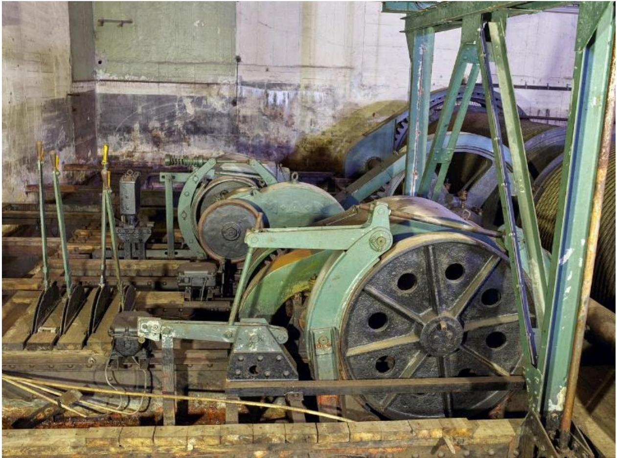
Vue des commandes du treuil et des deux moteurs électriques avec leur frein à tambour. Le bloc frein porte la marque allemande "M.A.N" (Maschinenfabrik Augsburg-Nürnberg)
