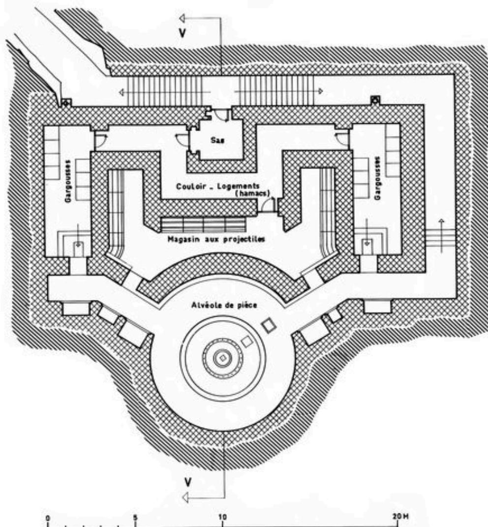
Plan de l'une des cuves à canon de la batterie du Cap de la Chèvre
