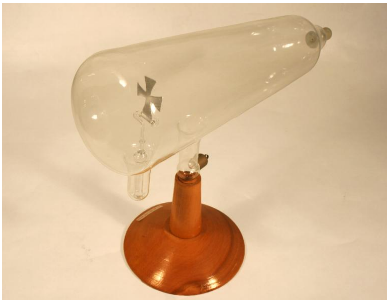
Tube de Crookes à croix de Malte - Electricité dynamique (Non signé)
