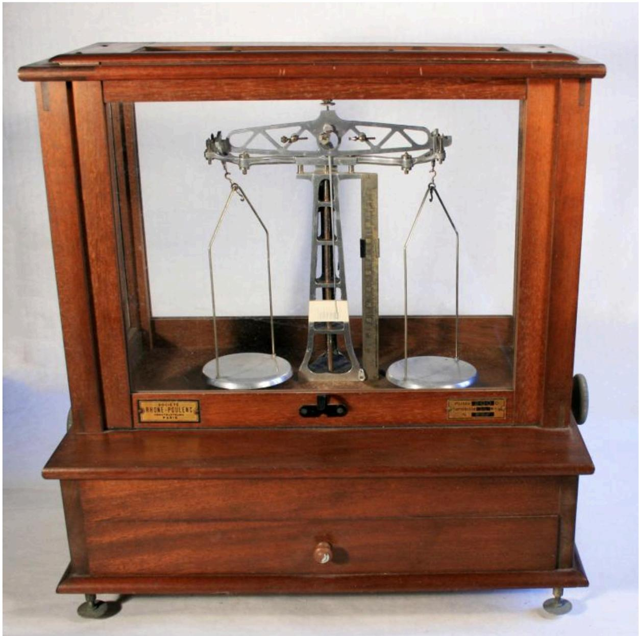
Balance de précision - Pesanteur-Mécanique-Mesure (Rhône-Poulenc)
