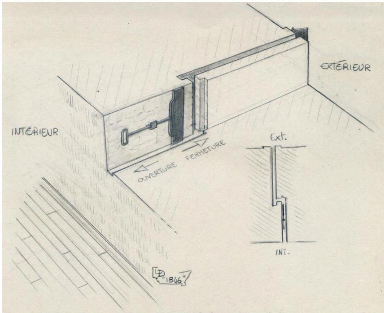
Le Palais, citadelle, magasin à poudre de l'Avancée, évent d'aération, système d'obturation toujours en place, schéma par Lionel Duigou.
