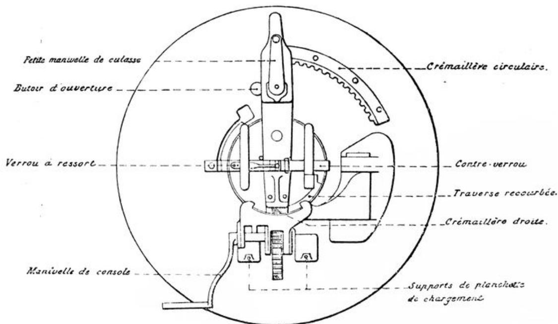
Plan détaillé de la culasse d'un canon de 32 cm modèle 1870-1881 (armement des batteries de Bertheaume, du Minou, du Mengant, du Dellec, du Portzic, du Corbeau, des Capucins, du Stiff et de la pointe des Espagnols)
